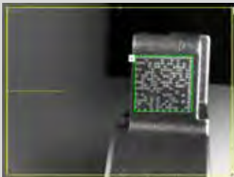
Code mit kleiner Ruhezone Auch Codes mit kleiner Ruhezone oder beschädigtem Finderpattern können gelesen werden.
